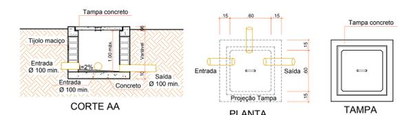
**DETALHE CAIXA DE INSPEÇÃO**
