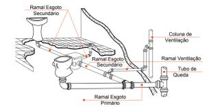
**DETALHE COLUNA DE VENTILAÇÃO**
