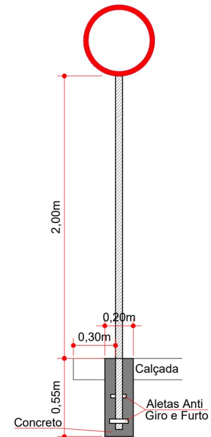
DETALHE DA FIXAÇÃO DE PLACAS
